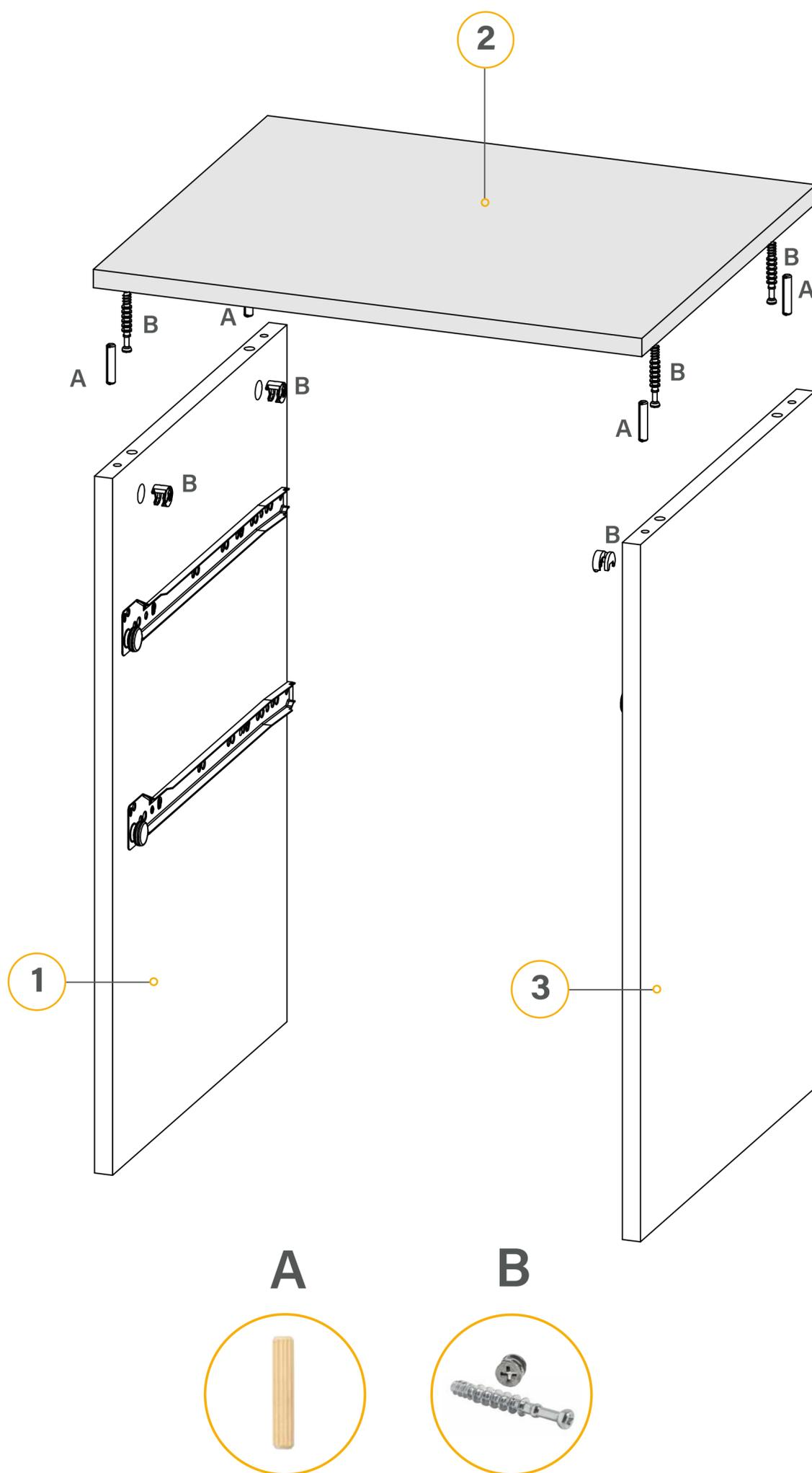
Tome el lado izquierdo n°1 y el derecho n°3 y coloque en ellos las casoletas del minifix (B) en las perforaciones de diámetro 15. Luego tome la tapa n° 2 y coloque los tornillos del minifix (B) en los cuatro perforados de menor diámetro. En los restantes coloque los tarugos 6x30 (A). Posicione la tapa y, una vez en su lugar, gire las casoletas de minifix para ajustarlas.
