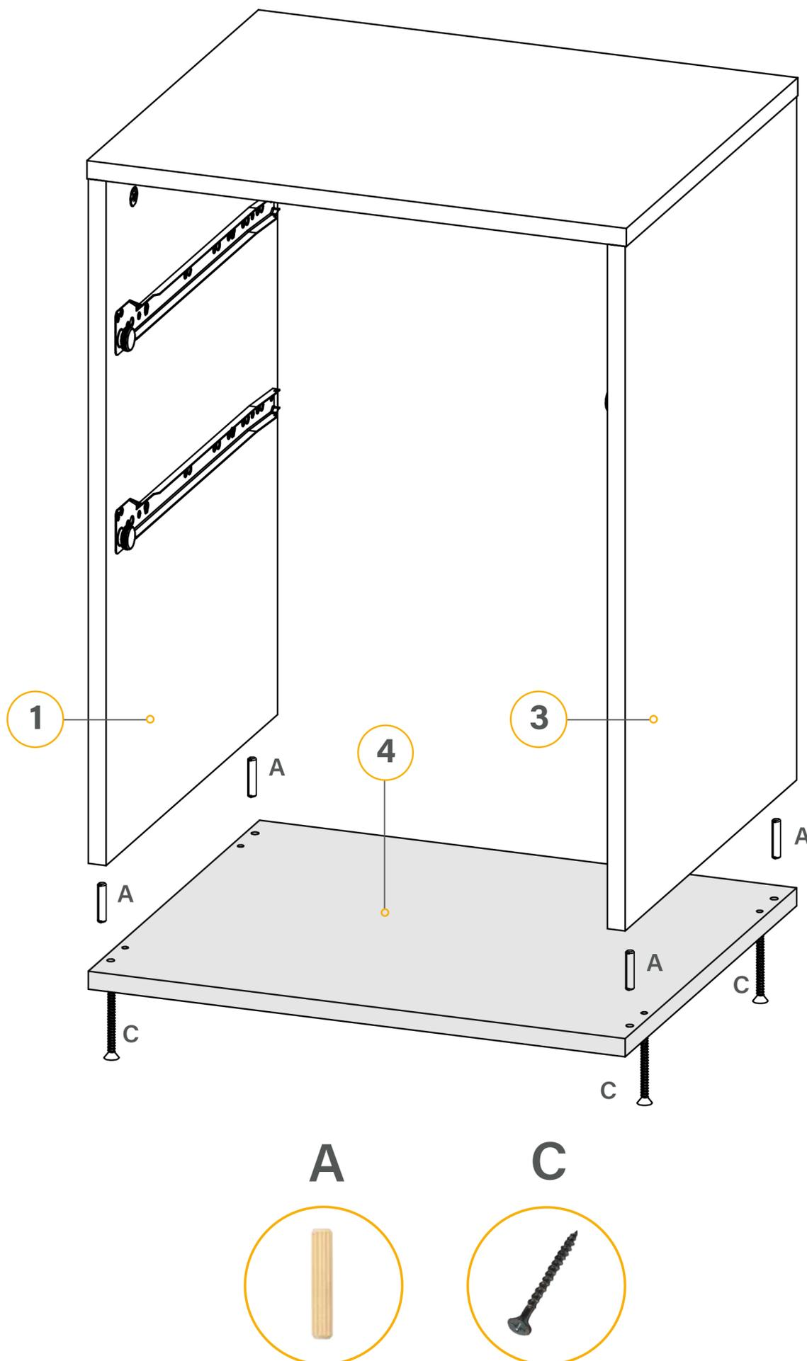
Tome la base n°4 y una a él el lado izquierdo n°1 y el derecho n°3. Utilice cuatro tarugos 6x30 (A) para alinear y luego ajuste con cuatro tornillos 4x50 (C).
