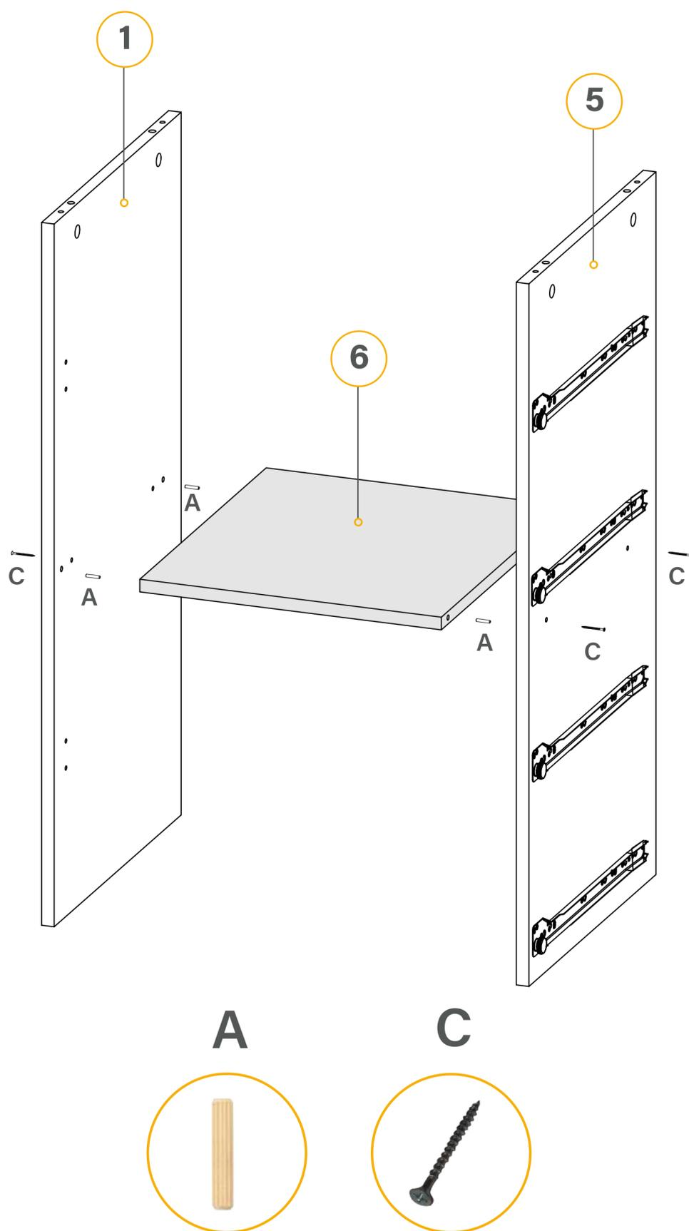
Una al tabique n°5 el divisor horizontal n°6 con dos tarugos 6x30 (A) y ajuste utilizando dos tornillos 4X50 (C). Repita el mismo paso con el lado izquierdo n°1.
