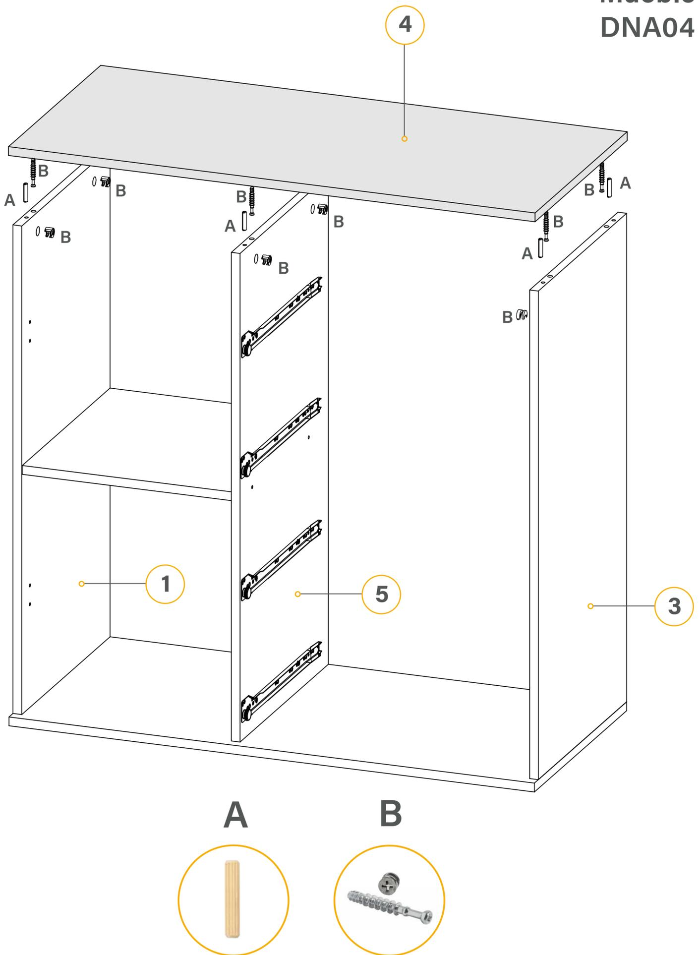
Tome la tapa n°4 y una a esta la estructura armada recientemente. Tome el lado izquierdo n°1, el tabique n°5 y el lado derecho n°3 coloque en ellos las casoletas del minifix (B) en las perforaciones de diámetro 15. Luego tome la tapa n° 4 y coloque los tornillos del minifix (B) en los seis perforados de menor diámetro. En las restantes coloque los tarugos 6x30 (A). Luego posicione la tapa junto con la estructura y, una vez en su lugar, gire las casoletas de minifix para ajustarlas.
