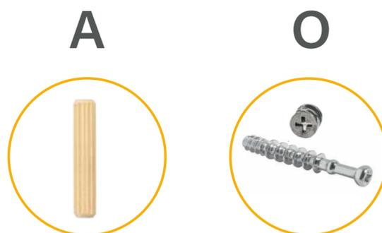
Arme las patas vinculando los zócalos lateral n°14 al zócalo posterior n°15 y al zócalo frontal n°22. Utilice 4 tarugos 6x30 (A) y cuatro minifix (O). Para colocar el minifix, primero coloque la cazoleta minifix en el perforado de 15mm de los zócalos laterales. Luego, atornille el tornillo minifix en el perforado del lateral frontal y posterior de diámetro 5mm. Por último, una y ajuste la cazoleta para fijar.
