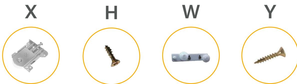
Del reverso de las puertas n°13 coloque en la parte inferior las ruedas con resortes (X). Use cuatro tornillos 3,5x14 (H) por rueda. En la parte superior, coloque las ruedas guía superior (W) y use tornillo 3,5x22 (Y). Coloque dos de cada una de las ruedas por puerta. Asegurarse de que las puertas tengan las manijas mirando una para cada lado.
