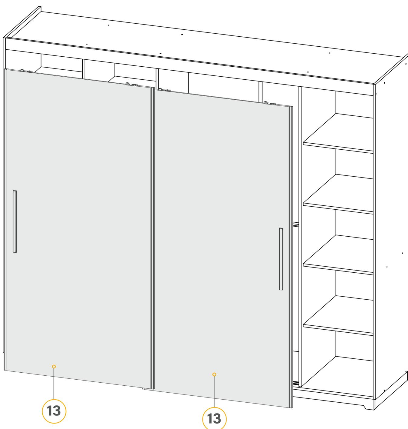
Coloque primero las puertas en la guía trasera, inserte la parte superior de la puerta dentro de la guía superior y luego calce la rueda sobre la guía inferior trasera. Repita la operación con la puerta sobre la guía delantera.
