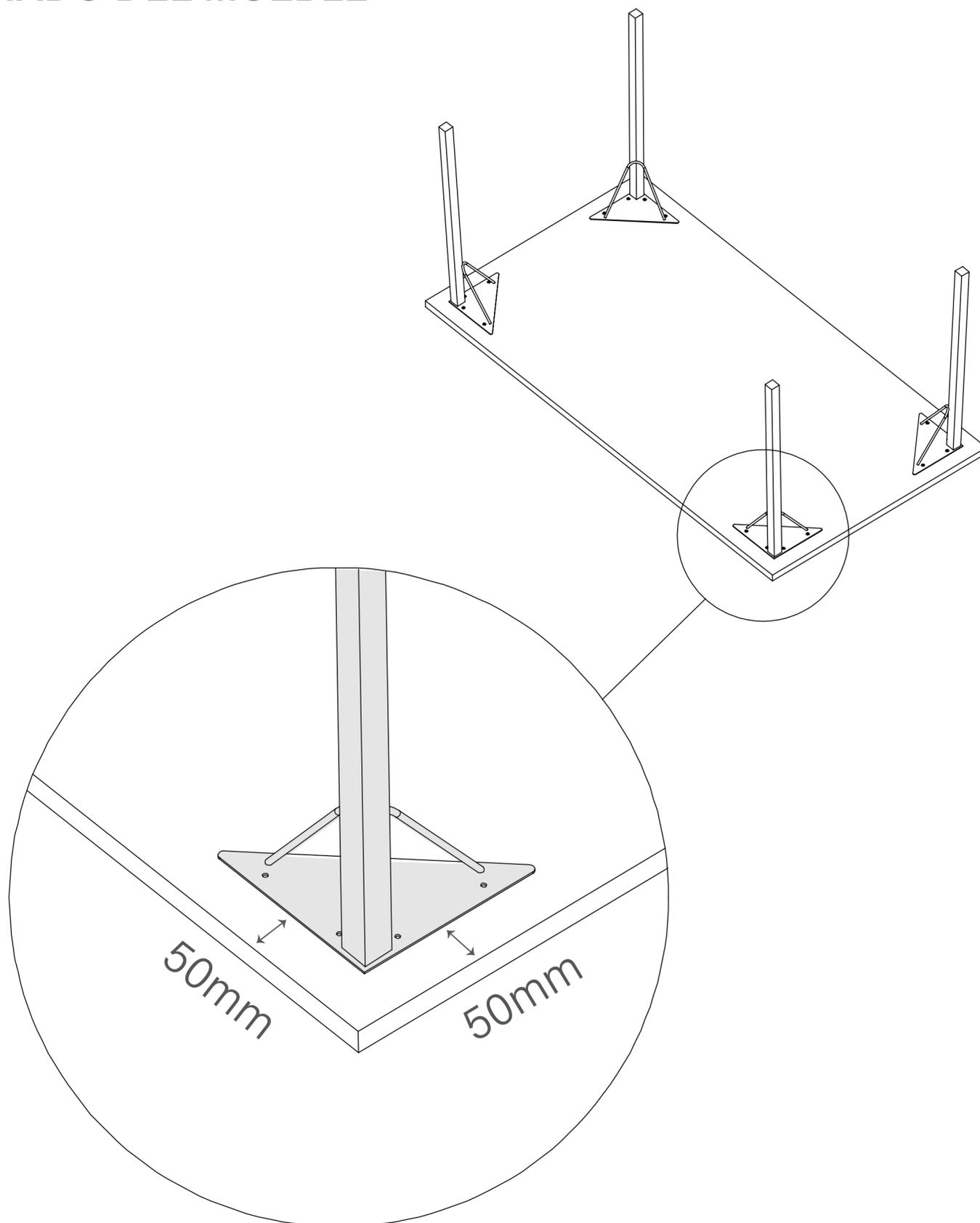
Colocar la tapa n° 1 sobre una superficie lisa y posicionar las 4 patas n° 2. La disposición de las patas queda librada a gusto del cliente. Se sugiere dejarlas a 50mm del filo de la tapa.
