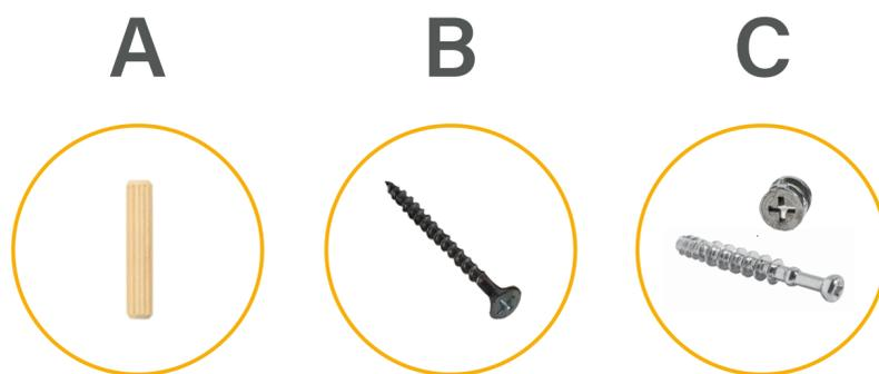
Coloque los laterales n° 1 y 3 y los tabiques n° 5 y 6 al piso n° 4. Use dos tarugos 6x30 (A) y dos tornillos 4,5x60 (B) por pieza. En los extremos coloque las cazoletas de los minifix (C).
