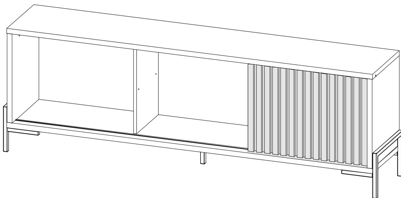
Coloque las puertas sobre el riel de aluminio, inserte la chapa guía en el canal superior. Ajuste los tornillos de la chapa guía.
