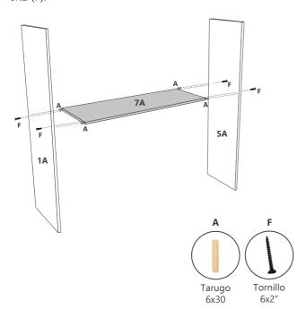
2 Tome la pieza (6A) y únala mediante mismos tarugos y tornillos a la pieza (5A).
