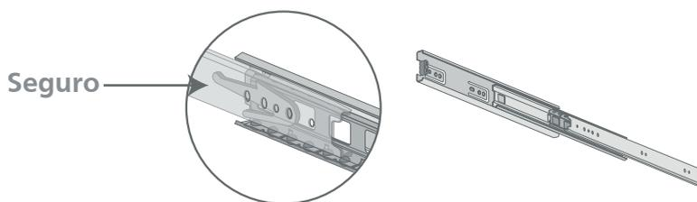
5 Tome la parte más fina y coloque en uno de los costados exterior del cajón con tornillos (D) . Repita la operación del lado opuesto. Reserve la parte gruesa de la corredera, se colocará en el cuerpo del mueble.
