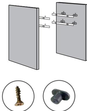
2 Tome el piso 4 y fije el costado derecho 3 y los tabiques 5 y 6 con tarugos (A) y ajuste con tornillos (B).
